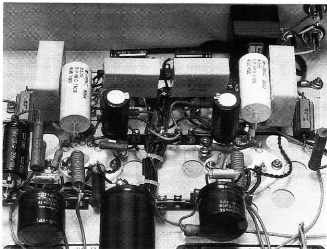
増幅部のワイヤリング。写真中央に二つ見えるラグ板のセンターに初段アース、出力段アースを各々いったんまとめた後、電源の330 \mu F500Vに集中させている
